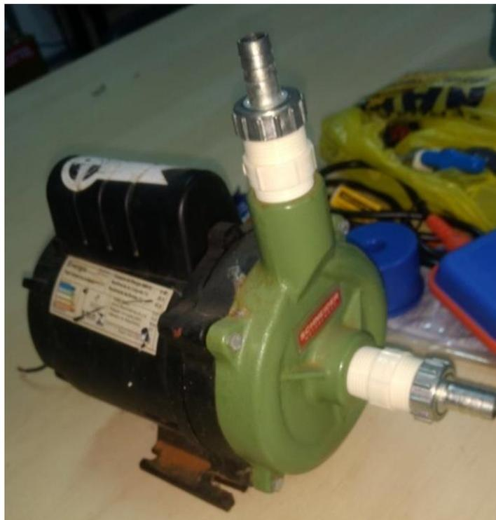
Figura 35 – Bomba centrífuga com paletas de metal utilizada no experimento.
