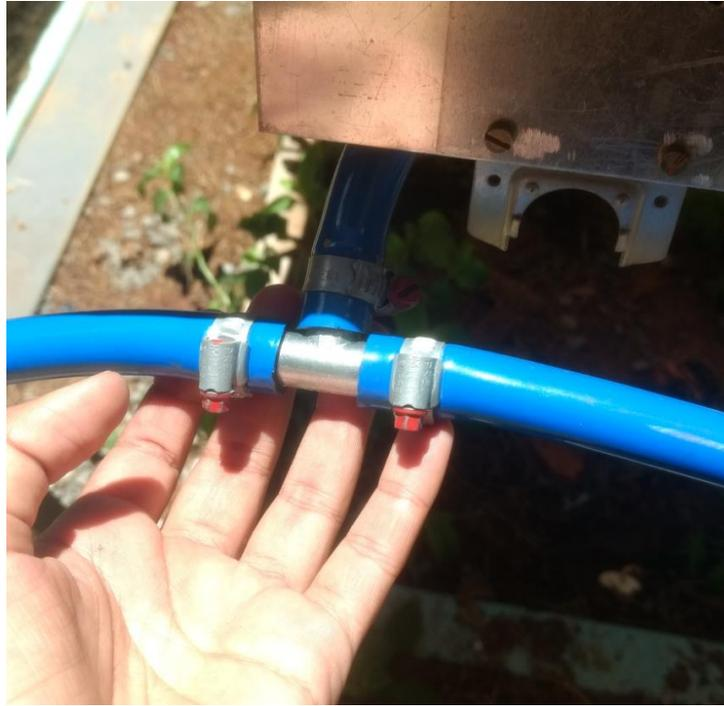
Figura 34 – Exemplo de conexões metálicas utilizadas no experimento.
