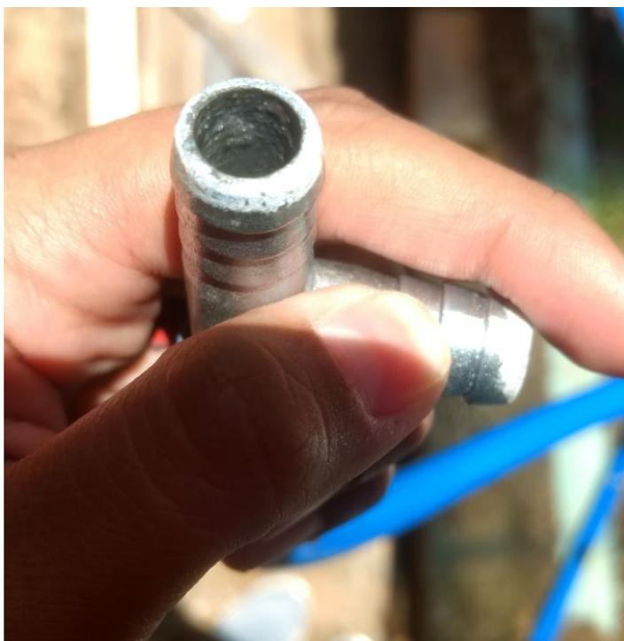
Figura 36 – Incrustações nas conexões metálicas utilizadas no experimento.
