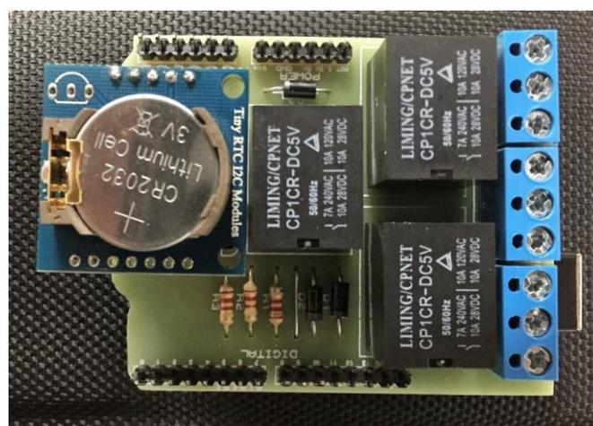
Figura 23 - Placa *Shield* desenvolvida para o acionamento de relés.
